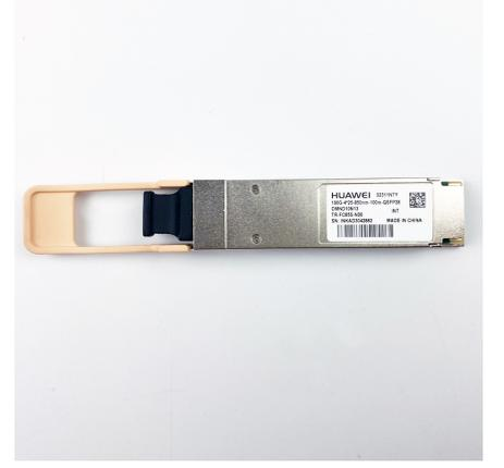
جهاز الإرسال والاستقبال عالي السرعة من Huawei ، QSFP28 ، 850nm ، 100G ، 2.4dBm ~ 8.4dBm- ، 10.3dBm- ، MM ، MPO ، 0.1km ، OM4
