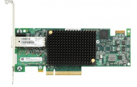
HPE STOREFABRIC SN1100E 16GB SINGLE PORT FIBER CHANNEL HOST BUS ADAPTER، 719211-001
