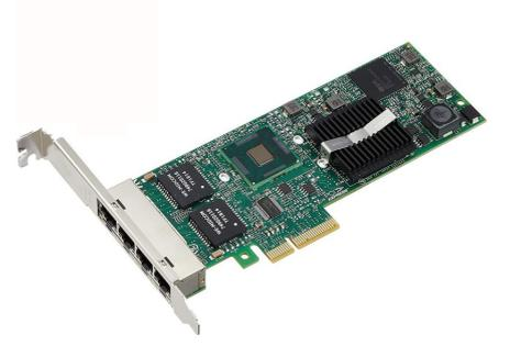
مهايي خادم رباعي المنافذ من ET2 Gigabit Intel ، 82576 ، Ethernet Gigabit ، منفذ رباعي ، Copper RJ45
