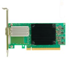
بطاقة مهايئ x16 PCIe3.0 ، QSFP28 منفذ واحد 100 EDR ، VPI 5-ConnectX ECAT-MCX555A Mellanox بطاقة مهايئ ، منفذ واحد x16 PCIe3.0 ، QSFP28 ، مامل طويل
