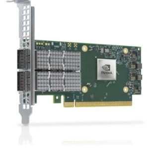
بطاقة مهائى Mellanox MCX623106AS-CDAT ConnectX 6-Dx EN ، 100 جيجابت ، منفذ مزدوج QSFP56 ، PCIe 4.0 x16 ، التمهيد الآمن ، بدون تشفير ، حامل طويل
